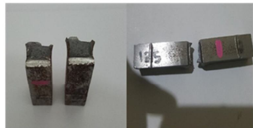
Gambar 8. Hasil uji Impact Sambungan las dengan arus 125 A
