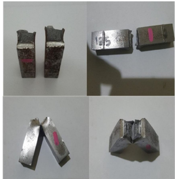
Gambar 25. Hasil Benda Uji Impact Sambungan Las Pada Arus Pengelasan 110 A & 125 A
