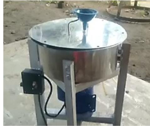
Gambar 2.8 Alat penyaring limbah minyak jelantah
