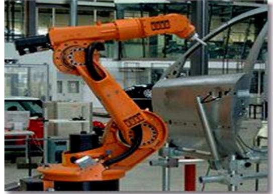
**Gambar 1.** Salah satu aplikasi *jig and fixture* untuk pintu mobil<sup>2</sup>.
