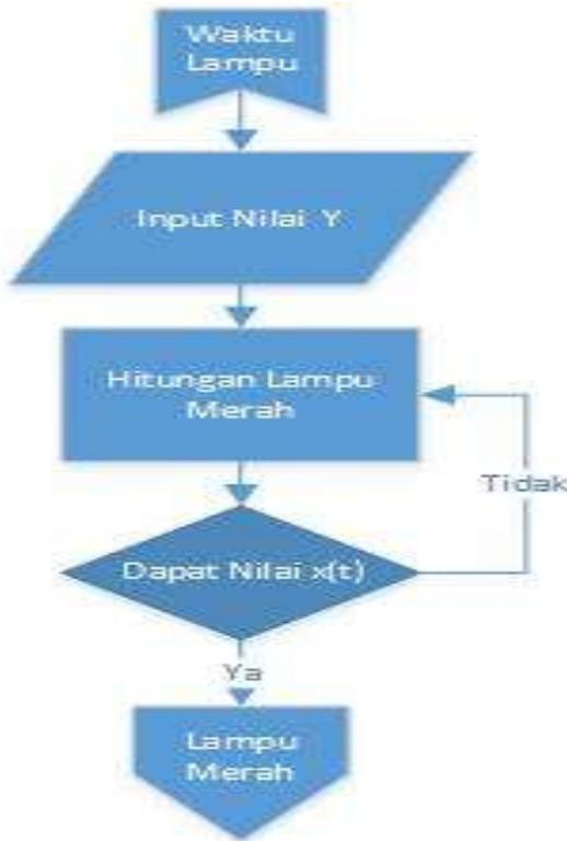
Gambar 5. Flowchart Program Menghitung Waktu Lampu
