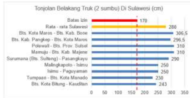
Gambar 5. Perbandingan Tonjolan Belakang Standar Truk (2 sumbu)
