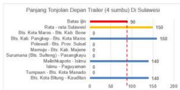
Gambar 12. Perbandingan Tonjolan Depan Standar Trailer (4 sumbu / lebih)
