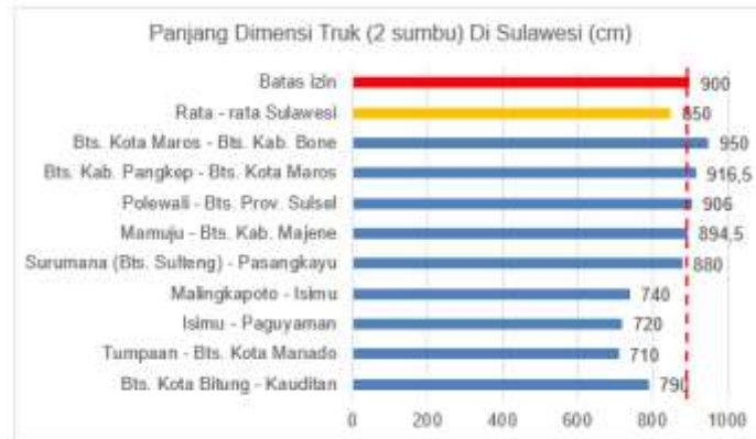
Gambar 3. Perbandingan Panjang Standar Truk (2 sumbu)
