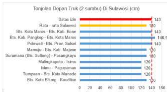
Gambar 4. Perbandingan Tonjolan Depan Standar Truk (2 sumbu)
