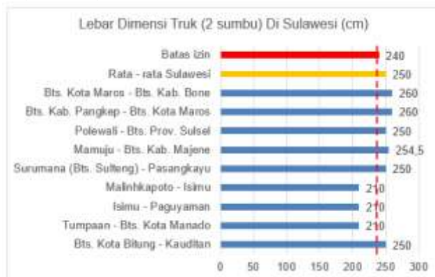
Gambar 2. Perbandingan Lebar Standar Truk (2 sumbu)
