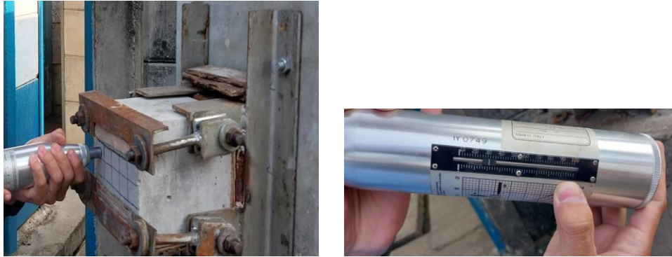
Gambar 2 Pelaksanaan Uji Angka Pantul dengan Alat Schmidth Hammer Test sudut 0°
