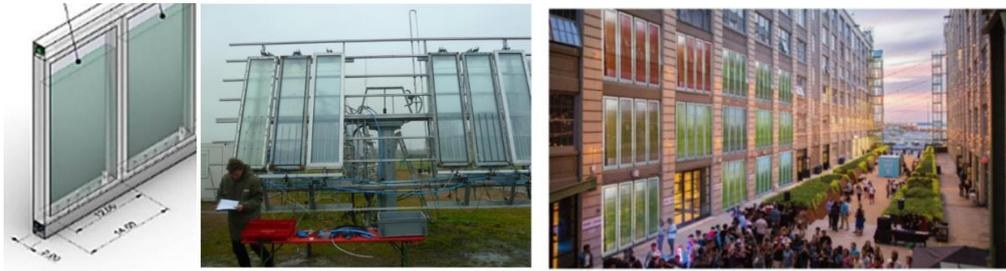
Gambar 8. Desain prototipe pelat bioreaktor mikroalga untuk diaplikasikan pada bagian fasad bangunan
