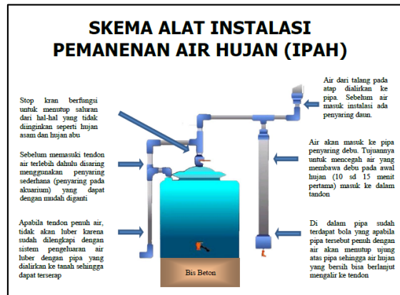
Gambar Foto 9: Contoh Skema Instalasi Penampungan Air Hujan Sumber : Sistem Informasi Konservasi Air dan Tanah
